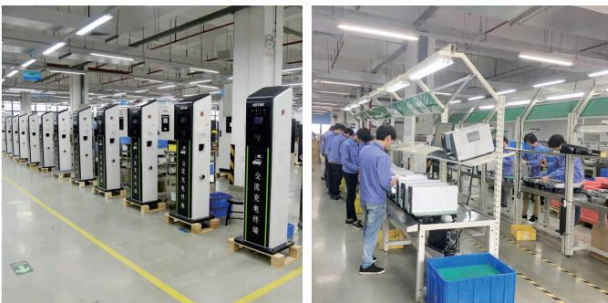
交流充电桩组装车间
