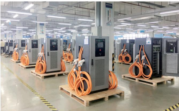
直流充电桩组装车间
